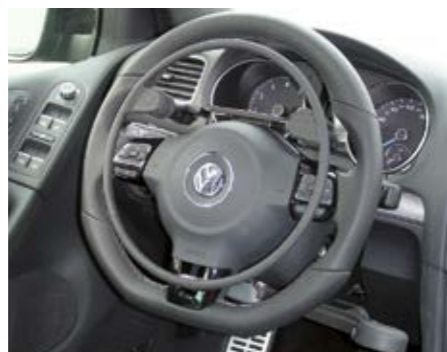
Acceleratore elettronico a cerchietto sopra il volante di tipo sfilabile e freno di servizio a leva. Codice comunitario 25.04 – 20.06
