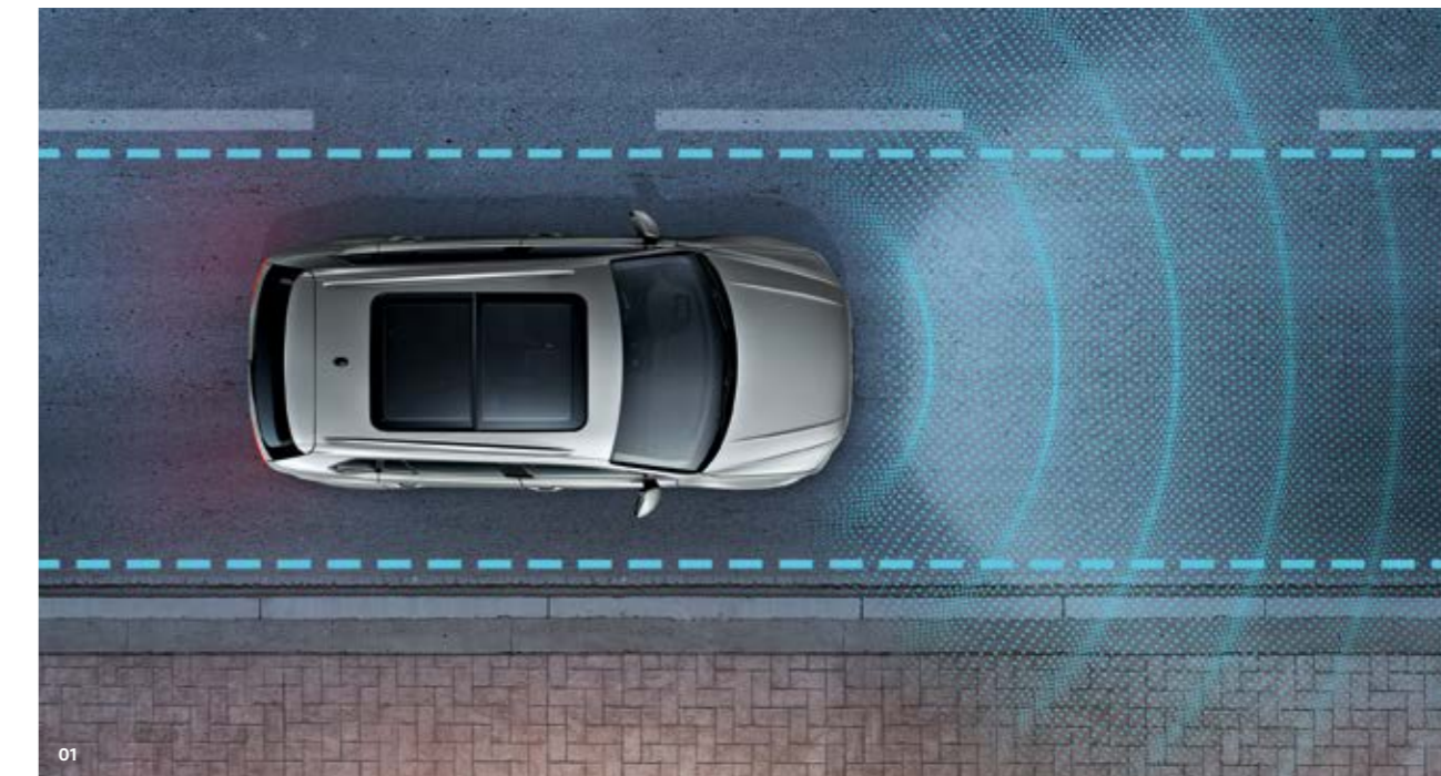
01 "Lane Assist" rileva, a partire da una velocità di 65 km/h, ogni scostamento involontario della vettura dalla propria corsia.
