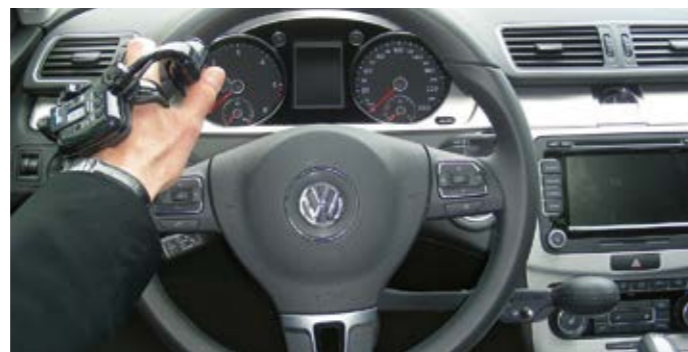
Acceleratore satellitare e freno di servizio a leva. Codici comunitari 25.04 – 20.06
