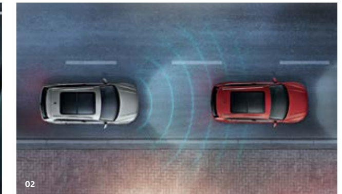
02 "Adaptive Cruise Control". Controlla automaticamente la velocità in base alla posizione dei veicoli che precedono per mantenere la distanza di sicurezza.
