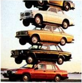
1966 Roll-bar incorporato nel padiglione
