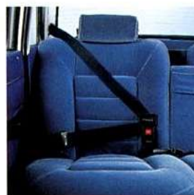
1972 Cinture di sicurezza posteriori a tre punti autoavvolgenti
