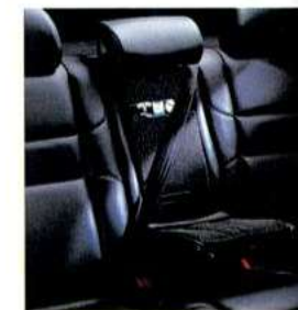
1990 Cintura a tre punti, autoavvolgente per il posto centrale posteriore e sedile per bambini integrato
