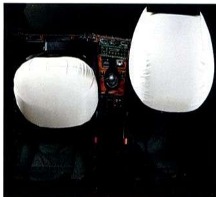
L'airbag per il pilota, di 65 litri, è alloggiato nel volante. Per il passeggero anteriore è disponibile, come optional, un airbag di ben 135 litri. In caso di forti urti si gonfiano in una frazione di secondo.
