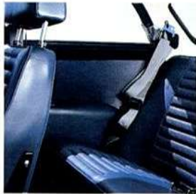
1967 Cinture di sicurezza posteriori a due punti
