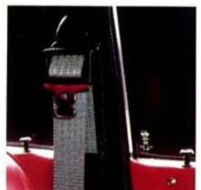
1969 Cinture di sicurezza anteriori a tre punti autoavvolgenti
