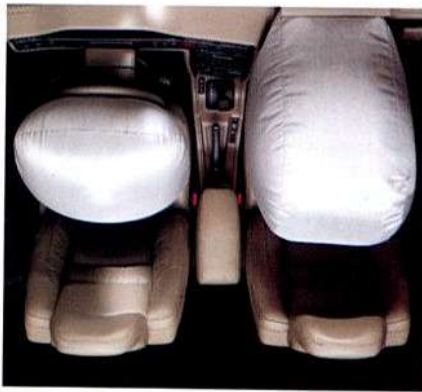
L'airbag per il pilota, di 65 litri, è alloggiato nel volante. Per il passeggero anteriore è disponibile, come optional, un airbag di ben 135 litri. In caso di forti urti si gonfiano in una frazione di secondo.
