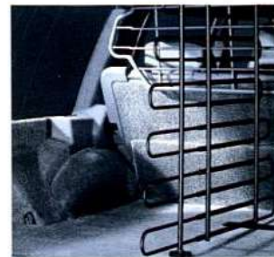
RETE DI SICUREZZA IN ACCIAIO - DIVISORIO DEL VANO DI CARICO
