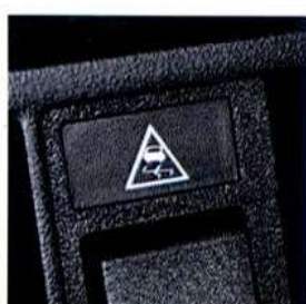
1984 ETC controllo elettronico della trazione
