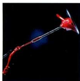
1974 Piantone dello sterzo scomponibile
