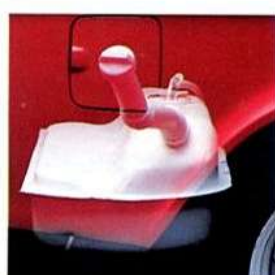
1974 Serbatoio isolato e protetto dagli urti
