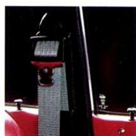
1969 Cinture di sicurezza anteriori a tre punti autoavvolgenti
