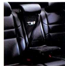
1990 Cintura a tre punti, autoavvolgente per il posto centrale posteriore e sedile per bambini integrato
