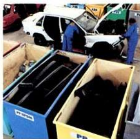
Nell'impianto pilota della Volvo per il riciclaggio si ricercano i metodi migliori per recuperare e riciclare i diversi materiali che compongono un'auto.
