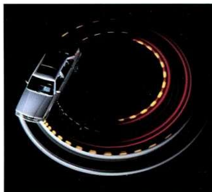
Il diametro di sterzata è di soli 9,7 metri. Poche auto, più piccole, possono vantare un risultato simile.
