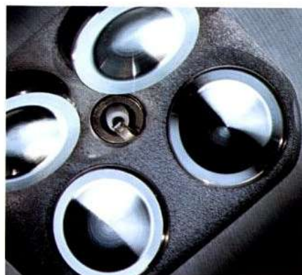
Con quattro valvole per cilindro il motore può "respirare" bene anche ad alto numero di giri, per disporre sempre della massima potenza.
