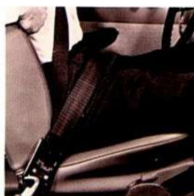
1959 Cinture di sicurezza anteriori a tre punti di attacco
