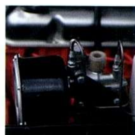
1965 Servofreno con limitatore
