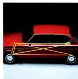
1966 Circuito frenante sdoppiato triangolare
