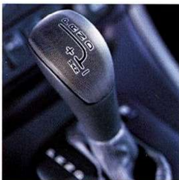
Il cambio automatico Geartronic a 4 velocità può essere usato anche manualmente quando volete una guida più dinamica. In questa funzione, cosiddetta sequenziale, ogni volta che spingerete la leva in avanti salirete di rapporto, mentre con il movimento verso di voi scalerete di marcia (soltanto per la Volvo S80 T6).
