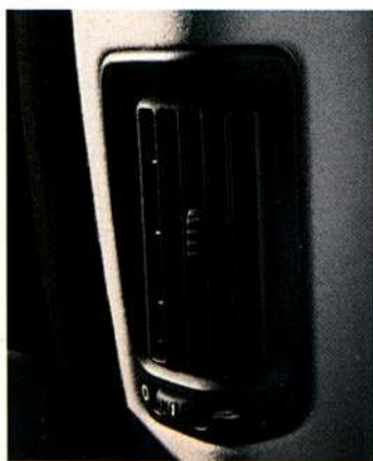
Il controllo della ventilazione separato per i posti anteriori e posteriori consente di ottenere la migliore temperatura e di evitare l'appannamento dei cristalli.
