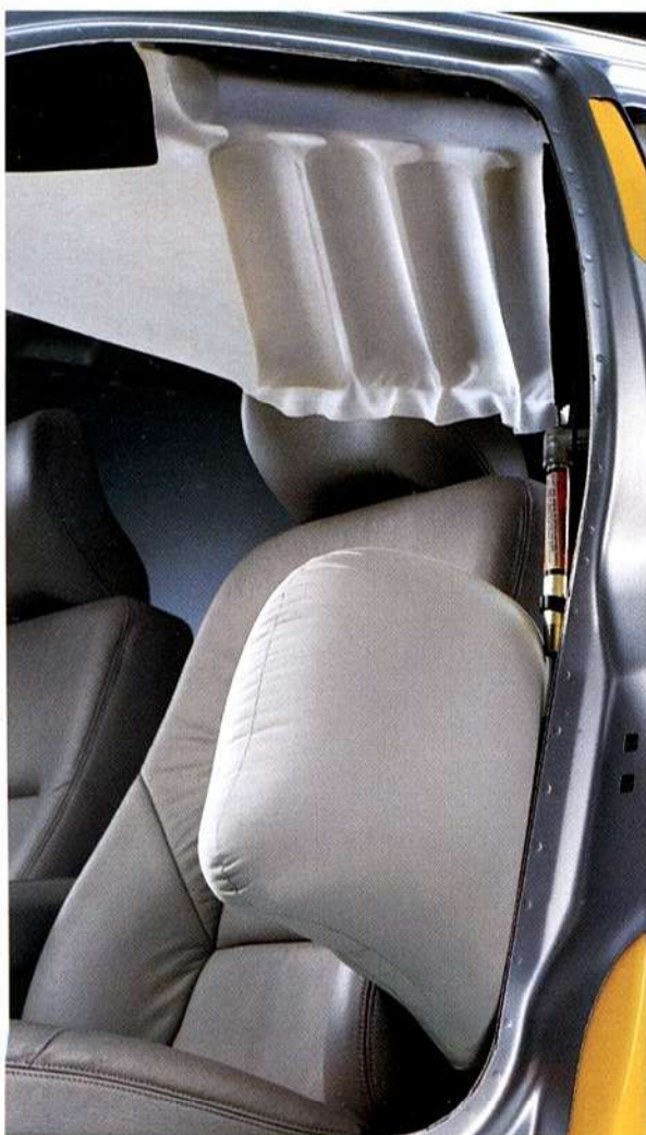
Il SIPS, unito agli airbag laterali e all'IC, fa della Volvo S80 un'autovettura molto sicura.
