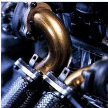
Il 272 CV montato sulla Volvo S80 T6 ha due turbocompressori di piccole dimensioni per una risposta sempre pronta.
