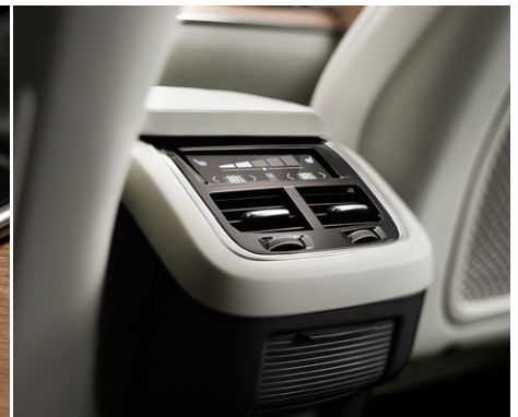
I comandi del climatizzatore a quattro zone sono azionabili dal touch screen del display centrale o dal pannello touch screen alla fine della consolle sul tunnel.
