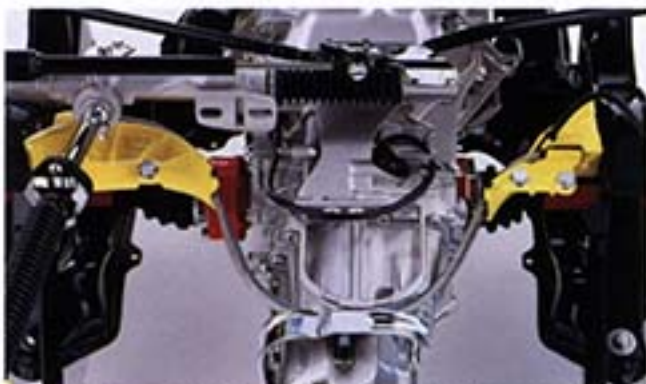
1/100秒でトランスミッションに設置されたワイヤーが作動する、プロコン-テン安全システム
