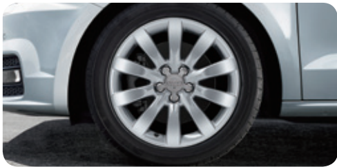
アルミホイール10スポークデザイン7)x16 +215/45 R16タイヤ [Audi A1 1.0 TFSI / A1 Sportback 1.0 TFSIにオプション]
