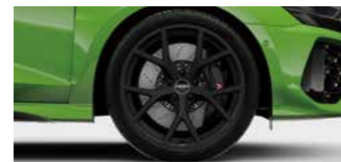
アルミホイール 5スポークYデザイン マットブラック (フロント9)×19+265/30R19タイヤ,リヤ8)×19+245/35R19タイヤ)*
