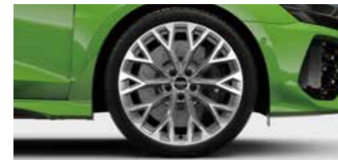
アルミホイール 10スポークYデザイン プラチナムグレー (フロント9)×19+265/30R19タイヤ,リヤ8)×19+245/35R19タイヤ)
