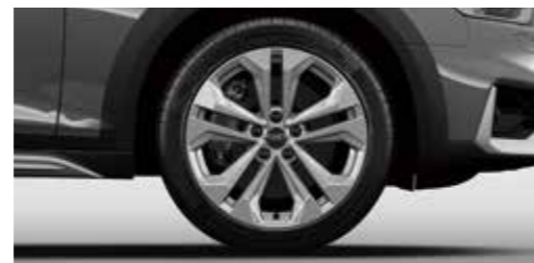
アルミホイール 5ダブルアームデザイン 7.5J×18+245/45 R18タイヤ [Audi A4 allroad quattro に標準装備]
