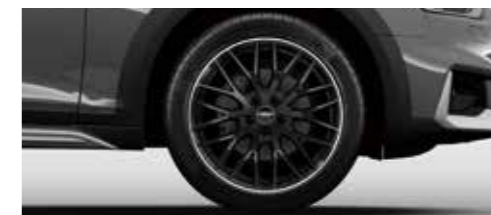
アルミホイール 10Yスポークデザイン グロスブラック 8J×19 (Audi Sport)+245/40 R19タイヤ [Audi A4 allroad quattroにスペシャルオプション]
