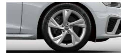
アルミホイール 5Yスポークデザイン 8J×18+245/40R18タイヤ [Audi A4 / A4 Avant 35 TFSI S line, A4 / A4 Avant 35 TDI S line, A4 / A4 Avant 45 TFSI quattro S line, 40 TDI quattro S lineに標準装備]
