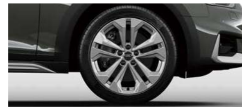
アルミホイール 5ダブルアームデザイン 7.5J×18+245/45R18タイヤ [Audi A4 allroad quattro に標準装備]
