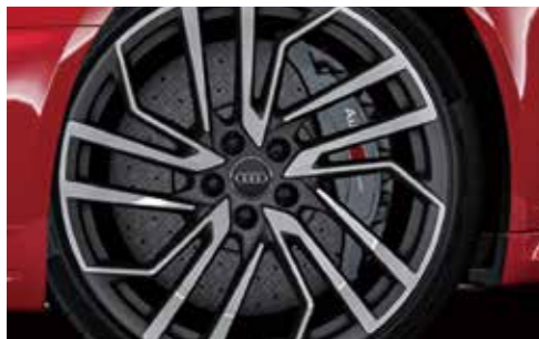
セラミックブレーキ(フロント) ブレーキキャリパー アンスラサイトグレー* *オプション
