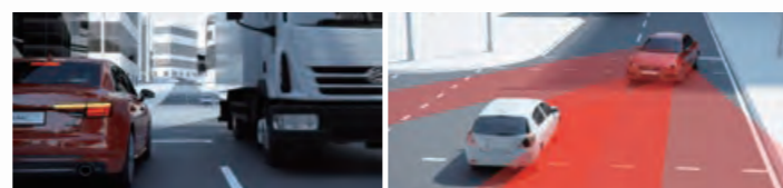
交差点などの右折時に対向車を検知。システムが危険を察知した場合、ブレーキを自動的に作動。
