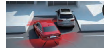
クルマを停める最適な間隔を感じ、ステアリング操作はシステムが行います。
