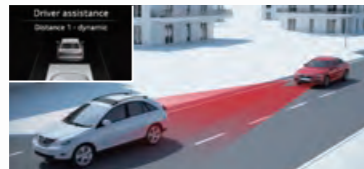
前方のクルマとの車間距離を一定に保ちます。設定された最高速度をキープ。
