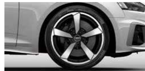
アルミホイール 5アームカッターデザイン アンスラサイトブラックポリッシュ 8.5]×19 (Audi Sport)+255 / 35 R19タイヤ [Audi A5 Sportback / A5 Coupé, S5 Sportback / S5 Coupéにオプション]
