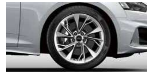
アルミホイール 5Vスポークデザイン 8.5J×18+245/40R18タイヤ [Audi A5 Sportback 35 TDI advanced, A5 Sportback / A5 Coupé 40 TDI quattro S line, A5 Sportback / A5 Coupé 45 TFSI quattro S lineに標準装備]
