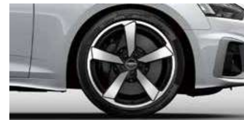
アルミホイール 5アームカッターデザイン アンスラサイトブラックポリッシュ 8.5J×19 (Audi Sport)+255/35R19タイヤ [Audi A5 Sportback / A5 Coupé, S5 Sportback / S5 Coupéにオプション]
