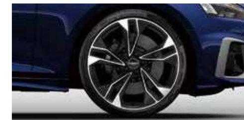
アルミホイール 5 ツインスポークポリゴンデザイン アンスラサイトブラックポリッシュ 9J×20 (Audi Sport)+265/30R20 タイヤ [Audi S5 Sportback / S5 Coupéにオプション]
