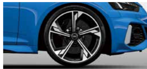
アルミホイール 5アームフラッグデザイン グロスアンスラサイト ブラックポリッシュ9J×20+275/30 R20タイヤ
