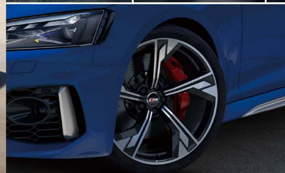
アルミホイール 5アームフラッグデザイン グロスアンスラサイトブラックポリッシュ 9J×20+275/30 R20タイヤ
