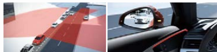
降車時に後方から接近する車両を検知。ドアハンドル近くのLEDの点灯によって乗員に危険を知らせます。
