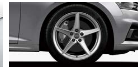
アルミホイール 5アームスターデザイン 8.5J×18 +245/40 R18タイヤ
