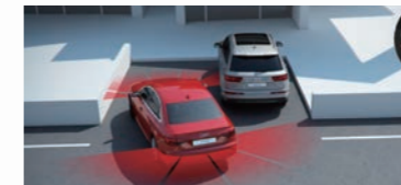
クルマを停める最適な間隔を感知。ステアリング操作はシステムが行います。
