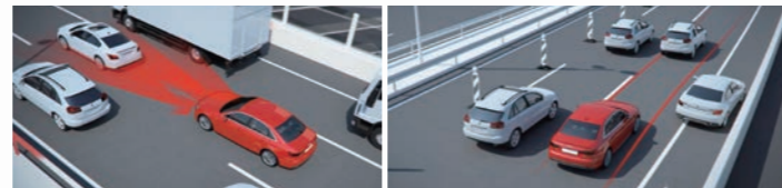
前走車との距離を一定に調整。周囲の状況を感じ、システムが走行路を導きます。
