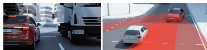
交差点などの右折時に対向車を検知。システムが危険を察知した場合、ブレーキを自動的に作動。
