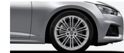
アルミホイール 10スポークデザイン 7.5Jx18 +245/40 R18タイヤ [Audi A5 Sportback 2.0 TFSI にオプション]
