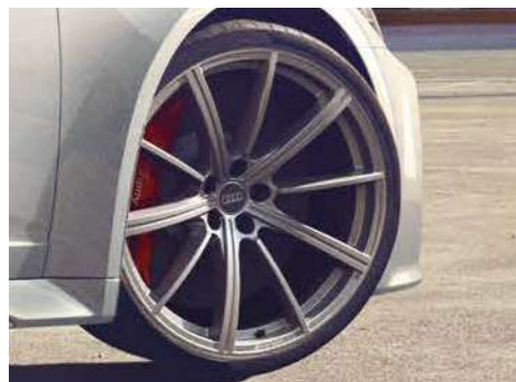
10スポークスターデザインアルミホイール 10.5J-21, インセット19, PCD112 (ウインタータイヤ用)
