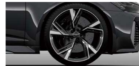
アルミホイール 5Vスポークグロスアントラサイトブラック 10.5J×22*
