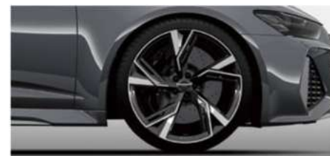
アルミホイール 5Vスポーク クロスアンササイトブラック 10.5J×22+285/30R22タイヤ*
