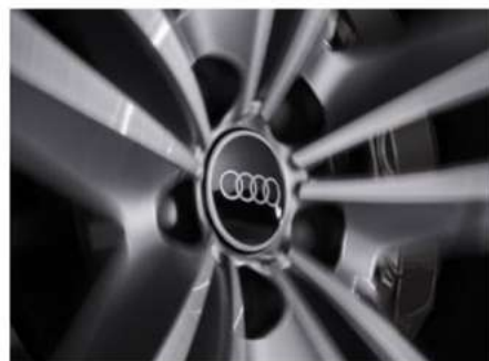
ダイナミックハブキャップ 走行中でも常にフォーリングスが水平方向を向いているハブキャップです。4個1セット。
