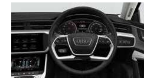
ステアリングホイール 4スポーク レザー マルチファンクション パドルシフト ヒーター
