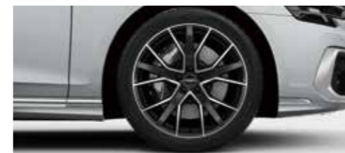
アルミホイール 5Vスポークスターデザイン グロスアンスラサイトブラック グロススタードフィニッシュ 9]×20+265/40R20タイヤ [Audi A8 60 TFSI e quattro, A8 L 60 TFSI e quattroにオプション]
