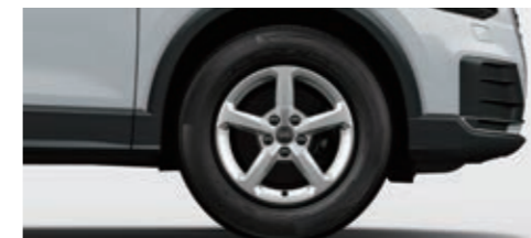
アルミホイール 5スポーク 6.5×16 +215/60 R16タイヤ [Audi Q2 1.0 TFSIに標準装備]
