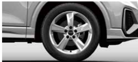
アルミホイール 5アームスターデザイン 7J×17+215/55 R17タイヤ [Audi Q2 35 TFSI S lineに標準装備]
