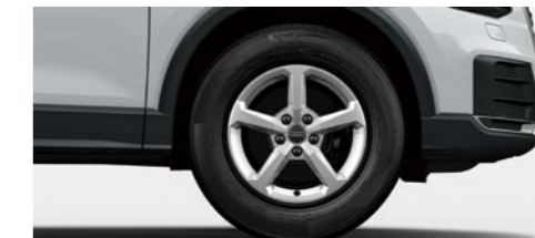
アルミホイール 5スポーク 6.5J×16+215/60 R16タイヤ [Audi Q2 30 TFSIに標準装備]
