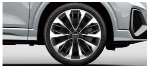
アルミホイール 5Vダブルスポークデザイン グラファイトグレー 8]×19+235/40R19タイヤ [Audi SQ2にオプション]
