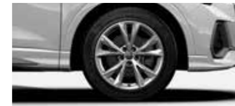
アルミホイール 5Vスポークデザイン 7]×18+235/55 R18タイヤ [Audi Q3 35 TFSI S line, Q3 35 TDI quattro S lineに標準装備]
