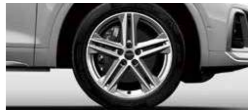
アルミホイール 5ツインスポークスターデザイン8)×19+235/55 R19タイヤ [Audi Q5 40 TDI quattro S line, Q5 45 TFSI quattro S lineに標準装備]
