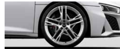
アルミホイール 5ツインスポークダイナミックデザイン (フロント: 8.5J×20 / リヤ: 11J×20) +フロント: 245/30 R20タイヤ / リヤ: 305/30 R20タイヤ [Audi R8にオプション]
