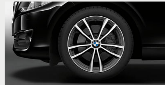
17インチ ダブルスポーク・スタイリング725 アロイ・ホイール：7.5J×17ホイール、225/45R17タイヤ(ランフラット・タイヤ)
