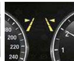
□ ドライビング・アシスト(レーン・ディパーチャー・ウォーニング(車線逸脱警告システム)、前車接近警告機能)：レーン・ディパーチャー・ウォーニング(車線逸脱警告システム)は、60km/h以上での走行時に、カメラを使って車両が意図せずに車線から逸脱するのを監視し、必要に応じてステアリング・ホイールを軽く振動させてドライバーに警告を促します。また、前車接近警告機能は、前方車両に近づき過ぎたり、衝突の危険を察知した場合に、2段階の警告を発します。
