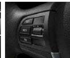
■ クルーズ・コントロール(ブレーキ機能付)：車速が約30km/h以上の場合、設定した任意の車速をキープすることができます。下り坂でも自動的にブレーキを作用させ車速を一定に保つブレーキ機能付。
