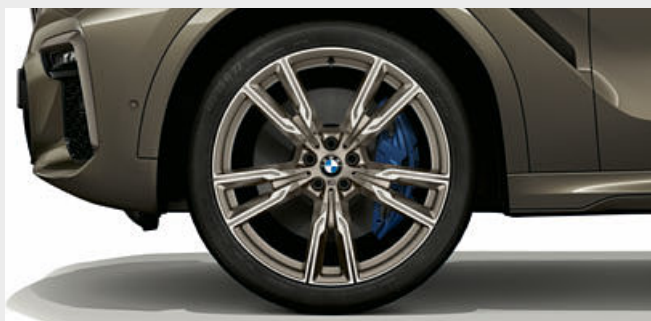
□ 22インチ M ライト・アロイ・ホイール Vスポーク・スタイリング747M* : (フロント) 9.5J×22ホイール、275/35R22タイヤ、 (リヤ) 10.5J×22ホイール、315/30R22タイヤ
