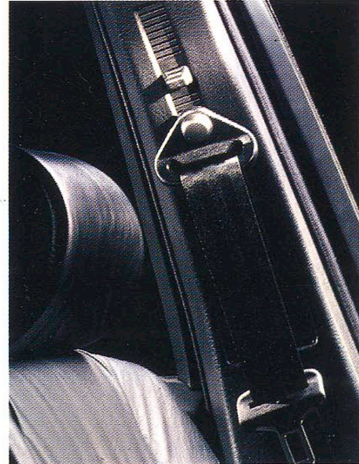
高さ調節可能なシートベルトアンカー
