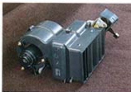
リヤヒーター(EX-TURBO, LX-TURBO, LX) リヤシート下に設置されたパワフルなヒーターで、足もとから室内を暖めます。(GX, GXiメーカーオプション。※車両は支脚にて固定ください。)
