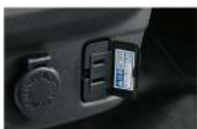
AC100V電源 メーカーオプション スマホなどの充電が可能。最大60W。
