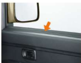
ドアアッパーガーニッシュ (フロントドア/スライドドア)
