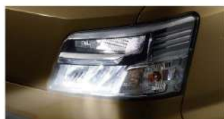
LEDヘッドランプ (ロー/ハイビーム・マニュアルレベリング機能・ LEDクリアランスランプ・オートライト付) L"SA III"には標準装備。
