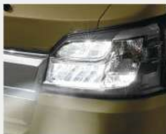
LEDヘッドランプ(ロー/ハイビーム・ マニュアルレベリング機能・LEDクリアランスランプ付)
