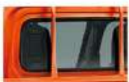
■ スモークガラス(リヤウインドウ) [ジャンボ「SA III」、ジャンボ、 エクストラ「SA III」に標準装備]
