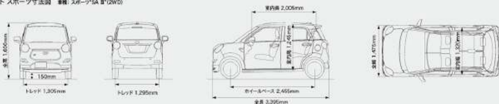
キャスト スポーツ寸法図 車種: スポーツSA II* (2WD)
