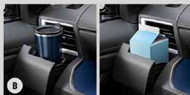
B 回転式カップホルダー(運転席/助手席) 角型パック、ペットボトルなどの丸型に対応。 閉じればスマートフォン立てにも使用可能。
