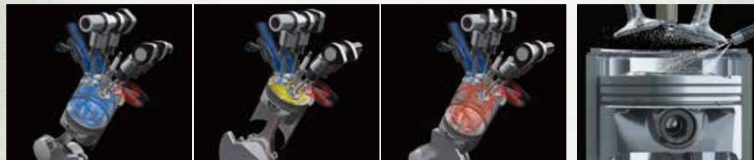
最適な噴射圧、最適な噴射タイミングで、最適量の燃料をシリンダーの燃焼室へ直接噴射。ピストンヘッドには、点火プラグに向かって混合気を集めるためのガイド成型が施されています。
