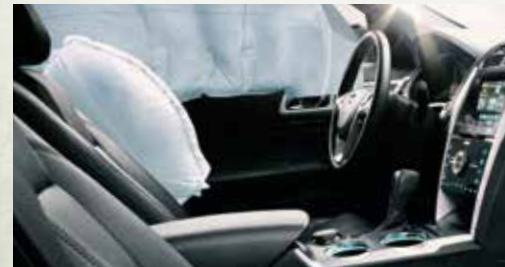
運転席/助手席SRSサイドエアバッグ 側面衝突をフロントドア及びCピラーのクラッシュセンサーが感知。前席のサイドエアバッグが展開して、ドライバーとパッセンジャーを守ります。サイドカーテンエアバッグと連動して、乗員の保護効果をいちだんと向上させます。
