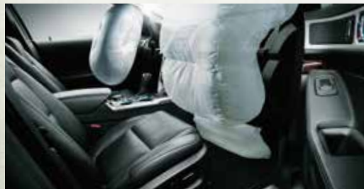
運転席/助手席SRSデュアルステージエアバッグ&助手席ニーエアバッグ 衝突の度合いに応じて2段階の膨張率でエアバッグを最適に展開する、先進のSRSデュアルステージエアバッグを運転席と助手席に装備。さらに、助手席ニーエアバッグが下肢をしっかりと受け止めて、同乗者の身体全体の保護効果をいっそう高めます。
