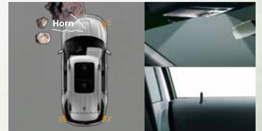
SOSポストクラッシュアラート(衝突後警音器等作動システム) 走行時に単独で木や岩と衝突事故を起こした場合などに、自動的にハザードランプを点滅させると共に、4秒間隔で3回のタイミングでホーンを鳴らし続けて、周囲に異変を知らせます。さらにルームランプを点灯させ、ドアロックを解除します。
