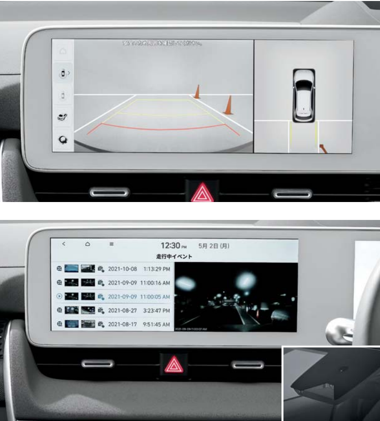
サラウンドビューモニター (SVM) 車両の周辺状況を俯瞰映像で表示できるので、安全な駐車がスムーズに行えます。 * SVM : Surround View Monitor ビルトインドラレコ [補助バッテリー 付き] 車両の前方・後方に装着された高画質カメラで撮影した映像をインフォテインメントシステムと連動し簡単に保存・再生することができます。また、タイムラボの録画や保存データズームイン機能もサポートします。
