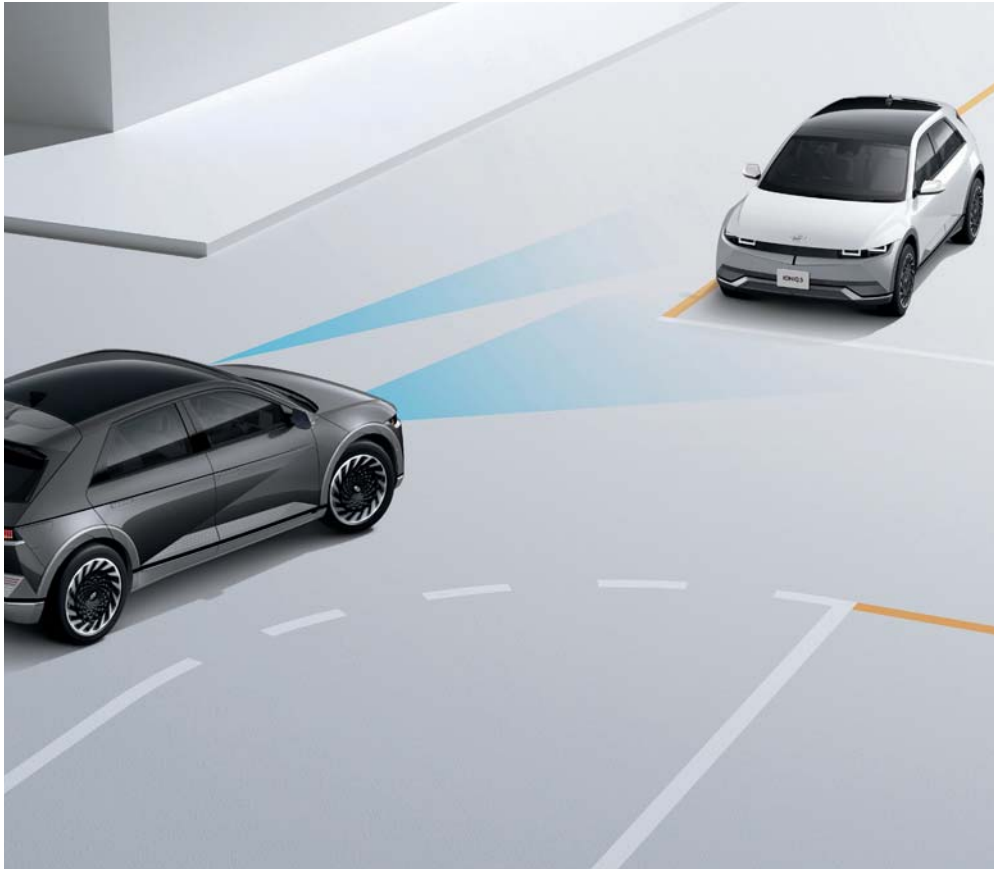
前方衝突防止補助（FCA） 先行車が急に減速したり、前方に停車中の車や歩行者がいるなど、前方衝突の危険が検知されると警告します。 警告後に衝突の可能性が高まった場合、自動的にブレーキをアシストします。 * FCA : Forward Collision-Avoidance Assist
