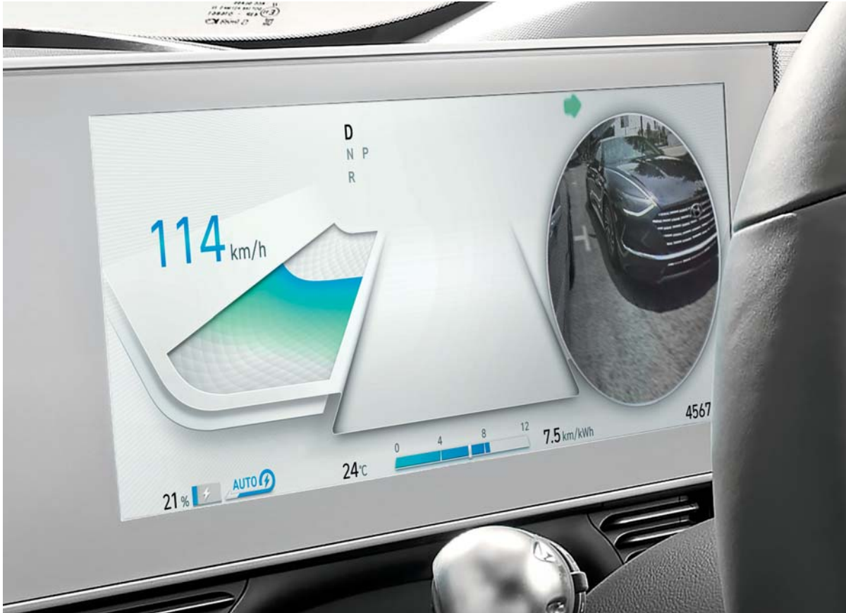
ブラインドスポットビューモニター (BVM) ウィンカー操作と連動して、車線変更の際にドアミラーのブラインドスポットの映像をクラスターに表示し、安全な走行を補助するシステムです。 * BVM : Blind-Spot View Monitor
