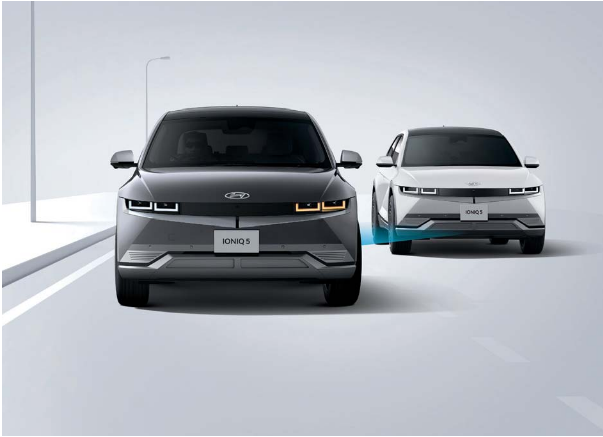
ブラインドスポットコリジョンアボイダンスアシスト（BCA） 車線変更のためにウィンカーを操作した際、後側方にある車との衝突の危険が検知されると警告します。 警告後に衝突の危険が高まった場合、自動的に車体を制御して衝突回避をアシストします。 * BCA : Blind-Spot Collision-Avoidance Assist
