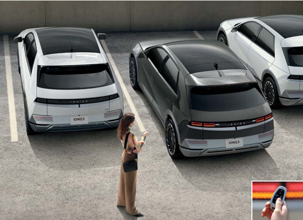
リモートスマートパーキングシステム (RSPA) 駐車補助機能を有効にした状態で、案内に従いスマートキーの作動ボタンを押すだけで、車両は自動で駐車します。 縦列駐車と並列駐車両方が可能で、車内の作動ボタンを押している場合、ドライバーが乗車中でも自動駐車をサポートします。 また、ドライバーが降車した状態でもスマートキーを使用して駐車と出庫を行うことができます。 * RSPA : Remote Smart Parking Assist
