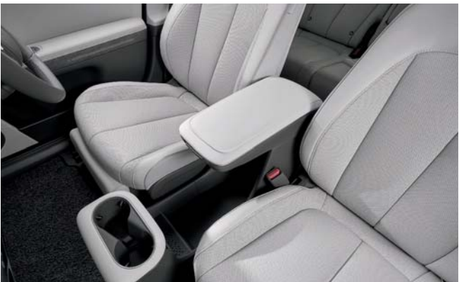
スライドコンソール 140mmまで移動可能なスライドコンソールは、前後に移動可能で、全座席の乗員すべてが室内空間をより柔軟に活用できます。 ドアの外に壁などの障害物がある際でも、左右どちらのドアからでも乗り降りしやすい構造となっています。後部座席からもカップホルダー、スマートフォンワイヤレス充電器、USB ポートなどの機能を使用することも魅力的です。 物を入れる空間のみならず、多彩な機能まで提供する全く新しい存在として誕生しました。
