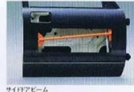
サイドアビーム (写真は車体内部にカラー塗装を施しています)
