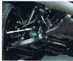
フロントダブルウィッシュボーン・トーションバー・スプリング式独立懸架
