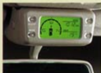
フィールドセンサー 方位、気圧、標準高度、相対高度、外気温の5つの情報を提供します。 (ロータス系、(カムシヤー系に標準装備)
