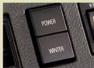
ウインターモード 3速発進を行うウインターモードを装備。雪道などの発進が容易になります。 (オプション/丁車に標準装備)
