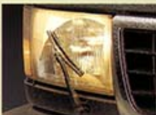
ヘッドランプワイパー&ウォッシャー 氷雪や泥が付着しがちなヘッドランプ。走行中でも常にクリアに保ちます。 (ロータス系、(カムシヤー系に標準装備)
