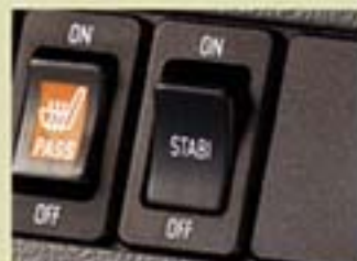
スタビライザークラッチ 路面状況に合わせて、ハードとソフトのふたつの走りが選べます。 (カムシヤー系に標準装備)
