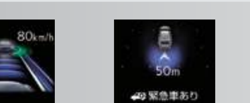
車車間通信システム (CVSS) 通信利用型レーダークルーズコントロール 交差点でウインカーを右に出して停車している時、対向車や歩行者がいるにもかかわらずブレーキペダルから足を離して発進しようとしているなど、接近している対向車や右折先の歩行者をドライバーが見落としている可能性がある場合に、表示とブザー音による注意喚起を行います。
