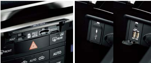
microSDカードスロット部 ※写真はオープン時。 USB (2個) / AUX (音声・映像*11) 入力端子
