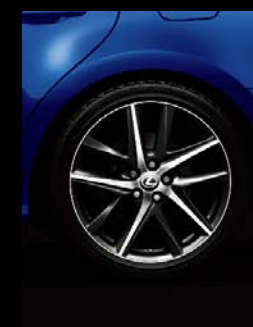
フロント235/40R19+ リヤ265/35R19タイヤ& "F SPORT"専用アルミホイール (切削光輝) *4
