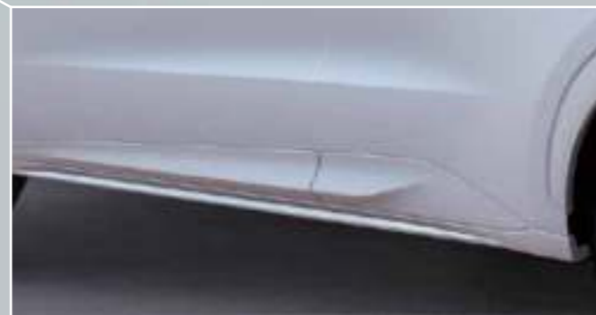
②ロッカー下端フィン形状によりフラット感を向上・旋回時のロールを抑制
