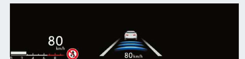
はみ出し通行禁止標識表示
